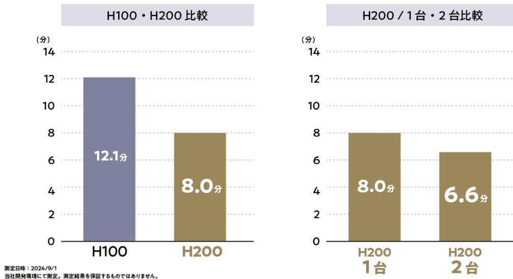
超高速で複雑な計算を行う強力なコンピューターシステムである HPC（ハイパフォーマンス・コンピューティング）クラスタ全体の GNN 学習性能を測定するベンチマーク性能において、H200 GPU は H100 GPU（12.1 分）に比べて、約 1.5 倍の高速化(8.0 分)を実現しました。【表 1】
