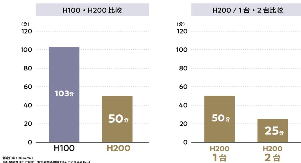
前述の GNN のベンチマーク結果と同様に、LLM においても、H200 GPU が H100 GPU と比べてメモリ搭載量が増加したことで、モデルがより GPU の性能を生かした学習を行えることがわかりました。
