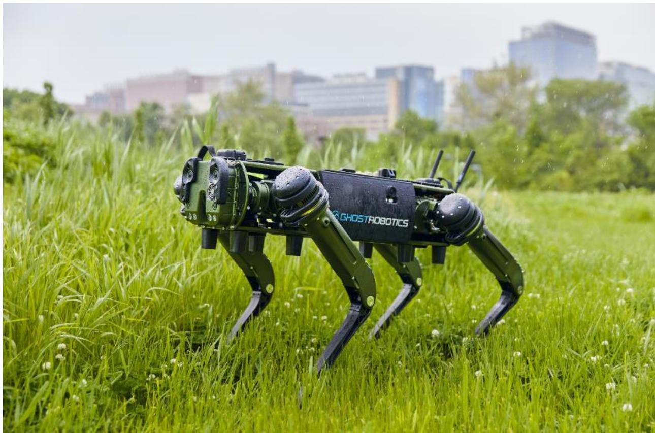
VISION 60 Q-UGV®は、世界最高の耐久性・堅牢性を誇る四足歩行型ロボットで、情報収集・監視・偵察等をあらゆる地形で実行する走破性を持ちます。遠隔操作や自律行動が可能で、カメラとセンサーより得た情報はリアルタイムで共有されます。また 10kg の積載能力を持ち、3km/h（最高速度 10km/h）で 3 時間稼働することが可能です。VISION 60 Q-UGV®は現在 25 以上の政府機関や産業顧客で警備や点検等に使用されています。
