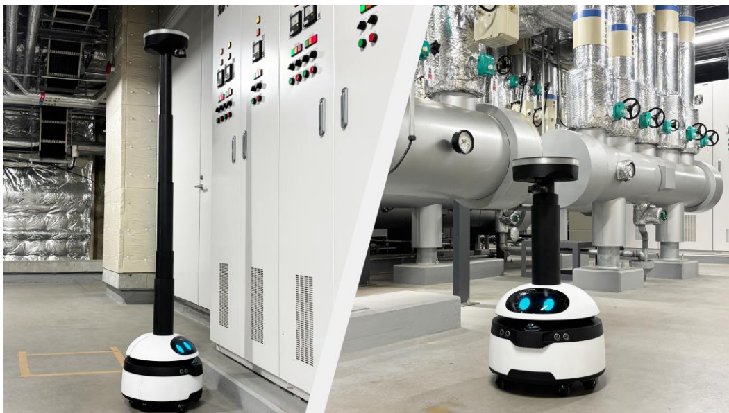
施設内を巡回する「ugo mini」。メーターを撮影するトップ部分に搭載されたカメラは 55cm から 175cm まで高さ調節が可能です。
